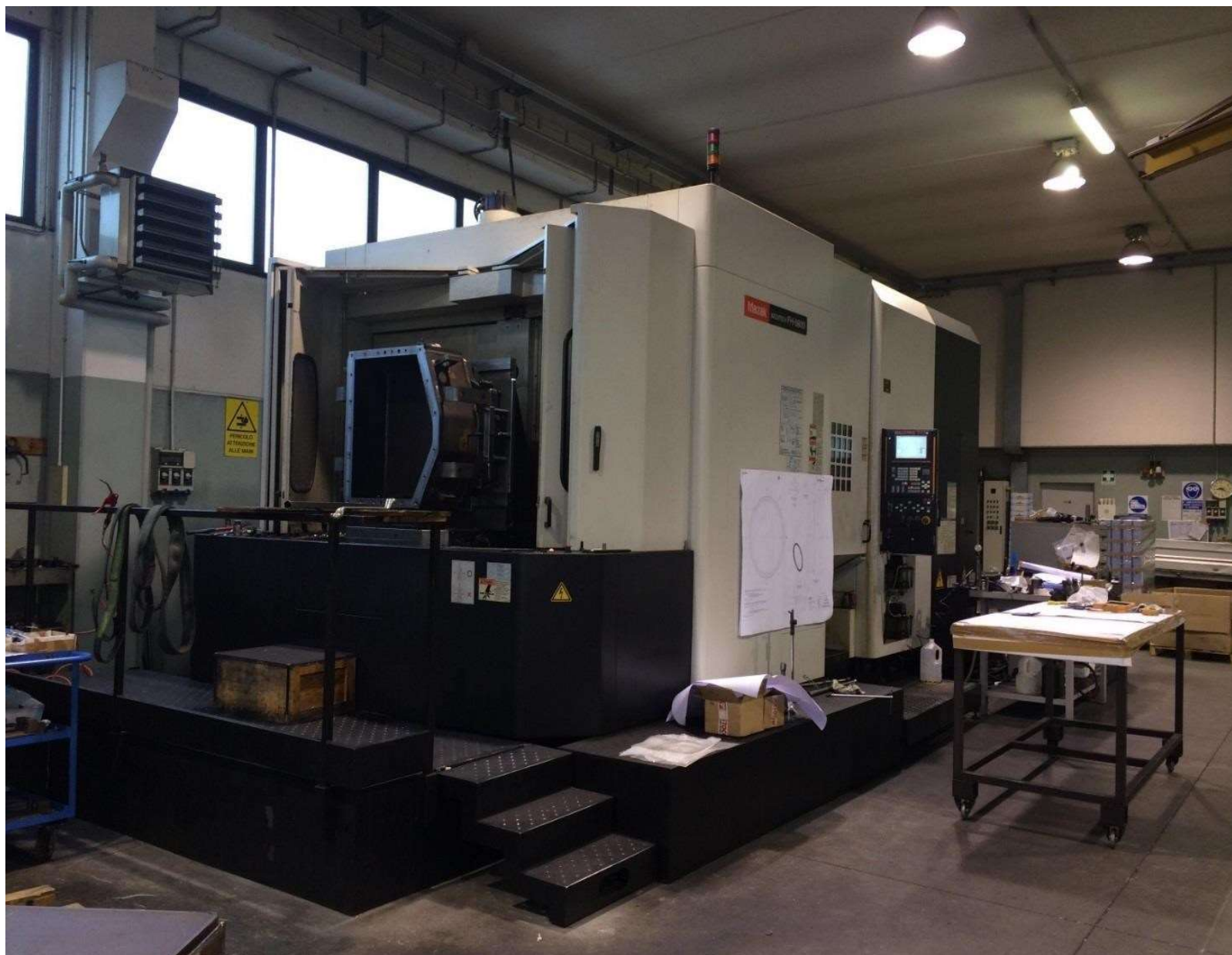
CENTRO ORIZZONTALE MAZAK MAZAKTECH FH 8800 X 1300 Y 1100 Z 1000
