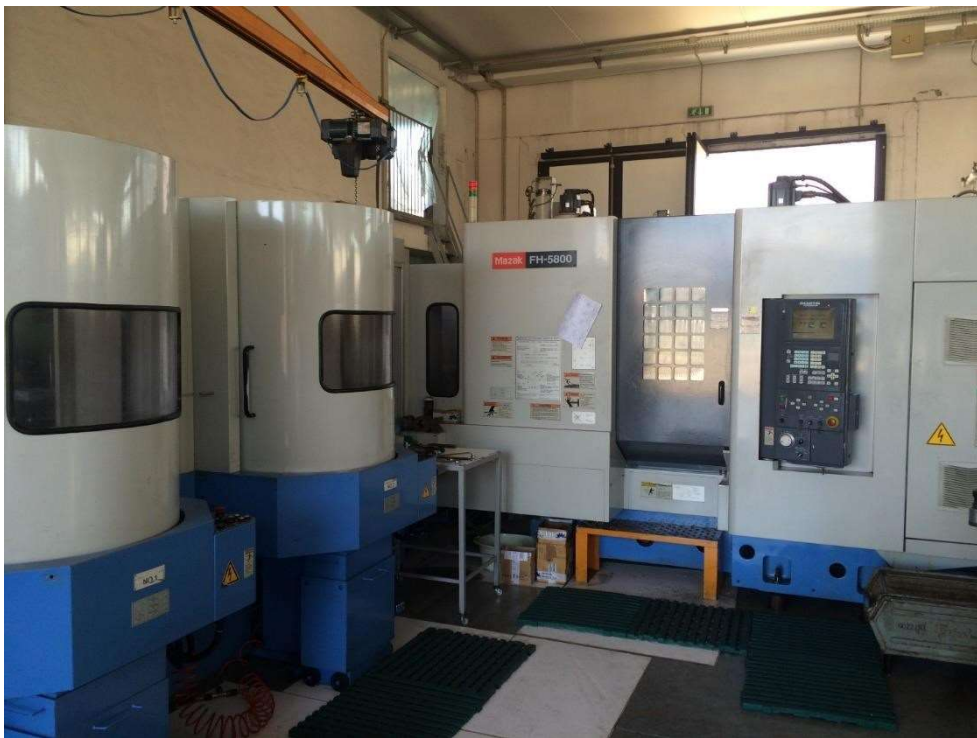
CENTRO ORIZZONTALE PHF 5800 + FH 5800 CON SISTEMA MULTIPALLETS 14 STAZIONI
